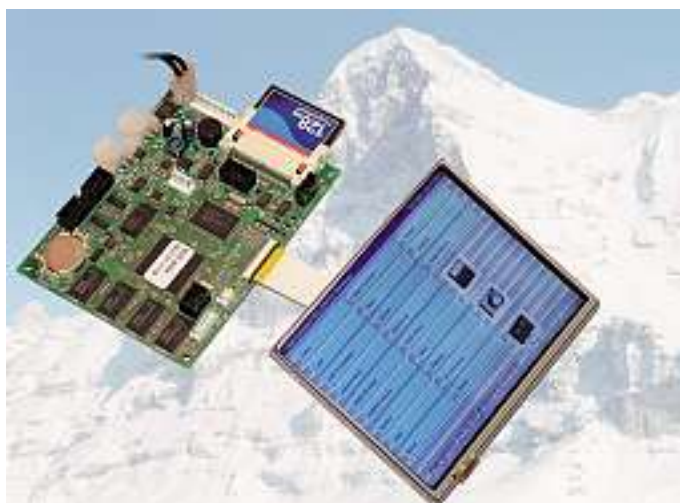
Das OEM-Kit eigerPanel 57 mit seinem 5,7"-Touch-Display kann direkt und platzsparend in die Frontplatte integriert werden
